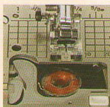
下糸のセットは、ガイドに沿って糸かけをするだけで完了します。下糸を引き出さずにぬい始められます。
