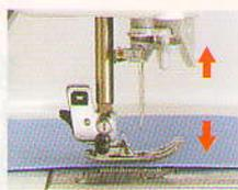
ミシンが止まっているときにボタンを押すと、はずみ車をまわさず、針の位置を切り替えられます。また、ボタンを長押しすると、極低速でぬうことができます。
